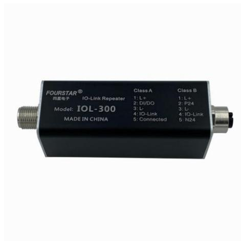
图 4-1 无需外接电源的 IO-Link 中继器实物照片
